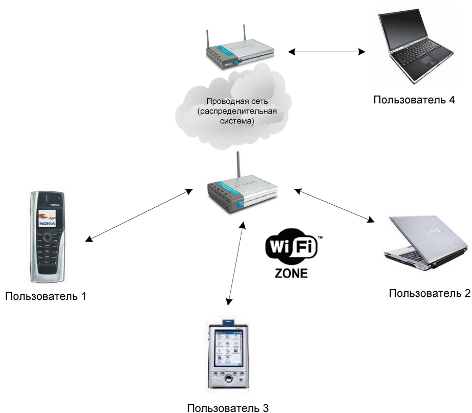
Рис. 4.7. Расширенная зона обслуживания ESS беспроводной локальной сети
